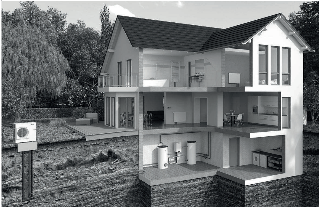
Rysunek 1. Dom wyposażony w instalację z pompą ciepła BLW Split
