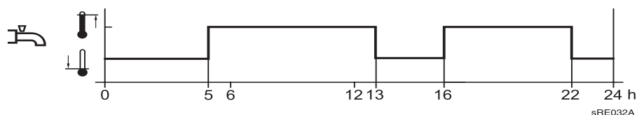
Rys. 16: Uruchamianie funkcji podgrzewania c.w.u. zgodnie z 4. programem sterowania zegarowego (przykład)
